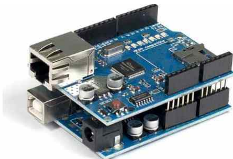
Figura 38: Conexión Ethernet Shield al Arduino Uno fuente: https://acortar.link/ceHOIj
