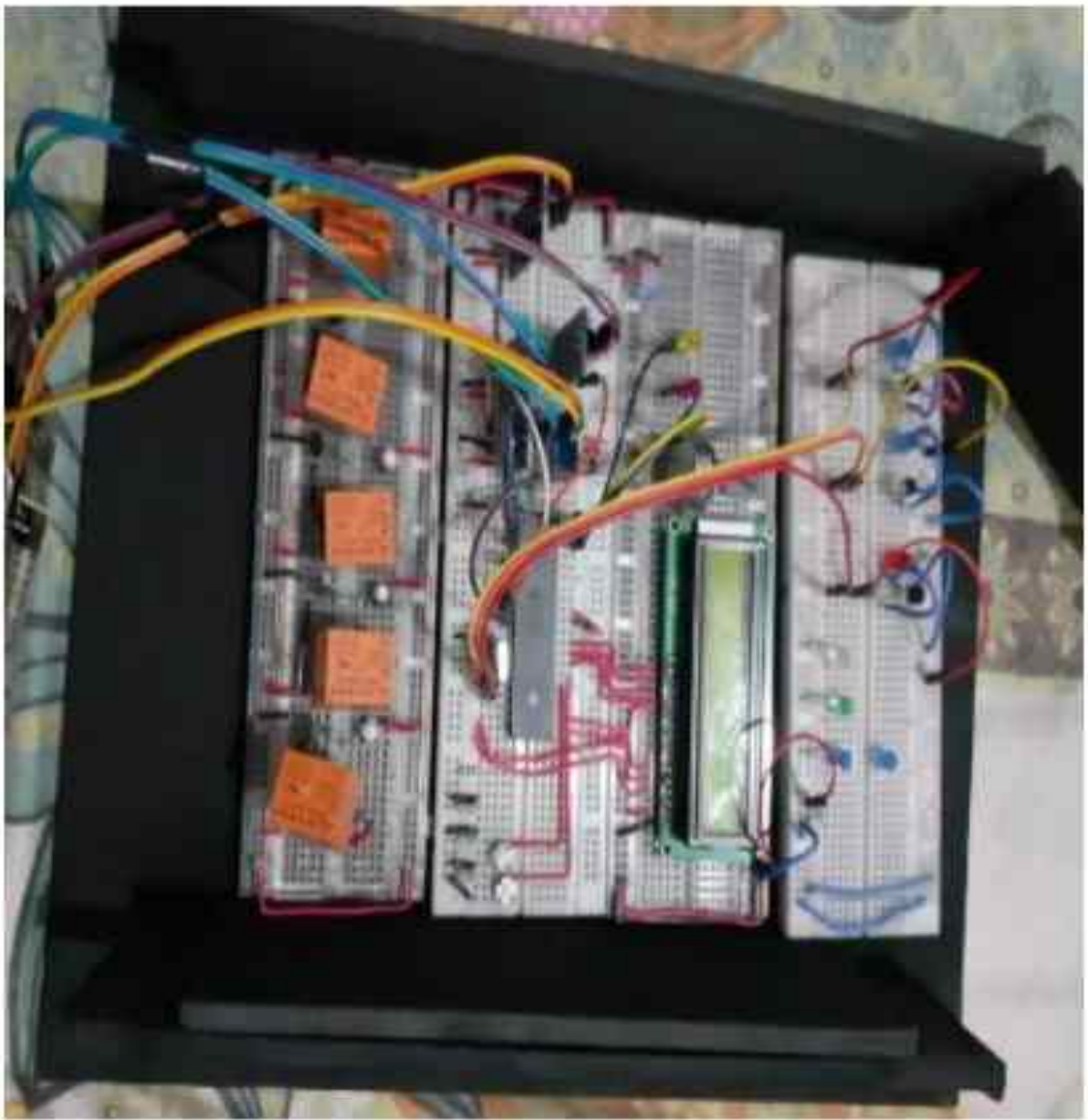
Figura 31: Sensores de Corrientes conectado al microcontrolador
