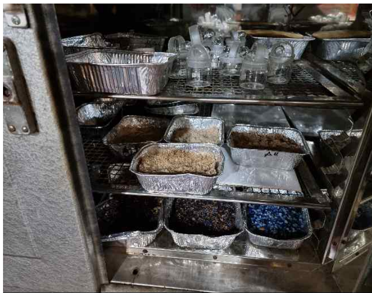
Figura 55: Eliminación de la humedad en la arena por medio del secado al horno
