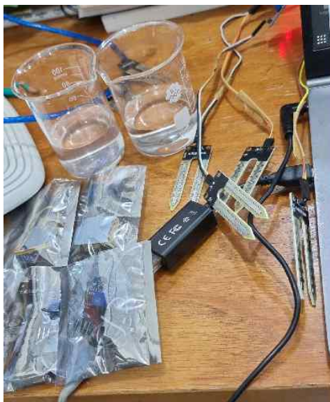
Figura 60: Cambio de sensores YL69
