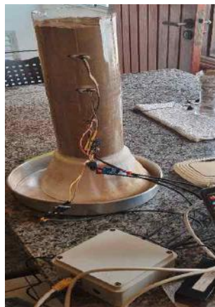
Figura 72: Perfil de suelo ARENA con sensores sin agua, con caja estanco
